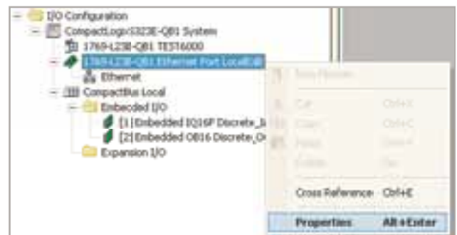
Figure 4.3.21h Emplacement du port Ethernet
