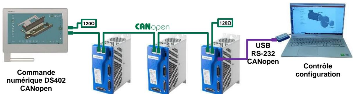
Le connectivité USB est disponible sur le connecteur X5. La communication RS232 ou CANopen est disponible via le connecteur X5-a. Le paramétrage de tous les axes peut se faire à travers une seule connexion au premier axe et le bus CANopen.
