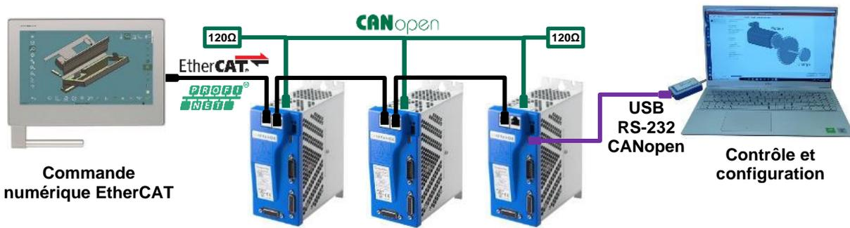
La connexion USB est établie à travers le connecteur X5.
