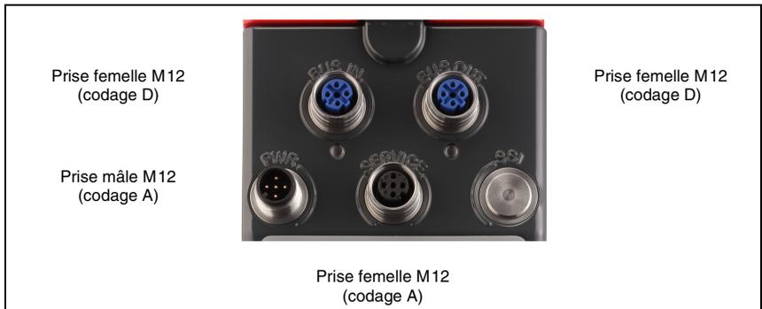
Figure 9.4 : Raccordements de l'AMS 348*i*
