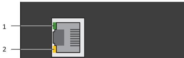
Fig. 54: Diodes électroluminescentes indiquant l'état de la connexion au réseau de maintenance
